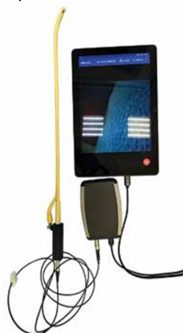
Рис. 3. Катетер уретральный оптический с портативным эндоскопическим комплексом в сборке
